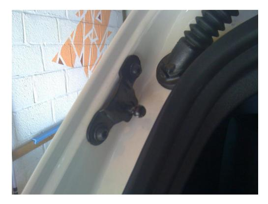
Den neuen Dämpfer einfach auf die Kugelzapfen aufstecken ohne dafür die Clips zu entfernen. Keine Angst die schnappen ganz leicht ein. Bei mir musste nur die Kugelpfanne etwas ausgerichtet werden dazu kann man den Kolben etwas mit der Hand verdrehen. Fertig
