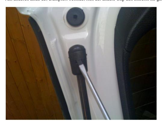
Dieser Kugelzapfen an der Klappe ist aber noch der OEM die neuen vom Golf 5 sind kürzer und ein wenig dicker.
